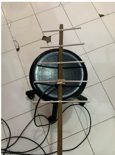
Gambar 4. Implementasi Antena Yagi Setelah di uji coba Antena yagi yang kami rancang menunjukkan kinerja yang optimal dengan
